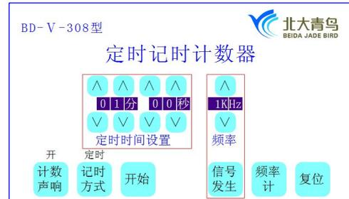
确定定时时间后，按“开始”键，发出开始声响，开始记时计数。时间显示倒记时，到达设定时间后，结束声响，记时计数自动停止。按“打印”键可以打印出相应的记时与计数。
