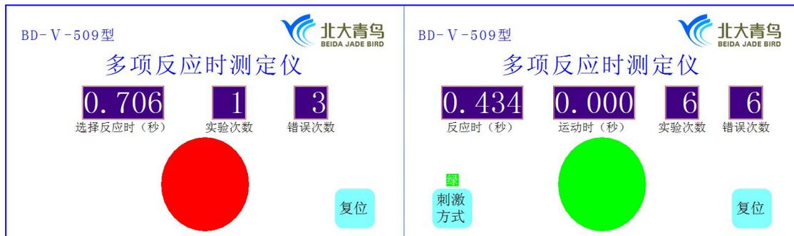
6. 重新开始，按“复位”键，设定的实验条件不变。中断实验，也可按“复位”键。
